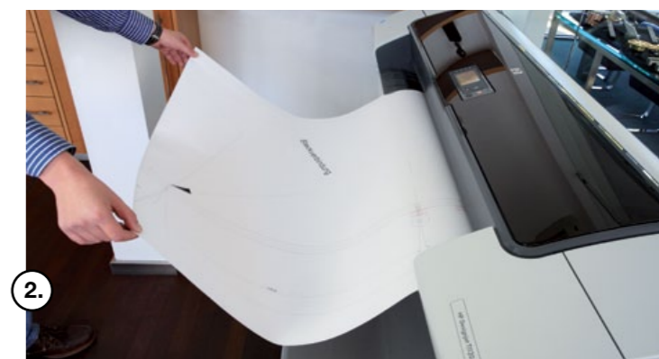
Wichtig für die Überprüfung und Maßhaltigkeit: Ein A0 Plott der Laufschienenkontur im Maßstab 1:1.
