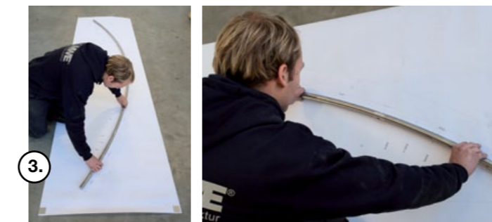
Der gefertigte Laufschienenbogen wird passgenau auf der Technikzeichnung ausgelegt und mit der Zeichnung abgeglichen.
